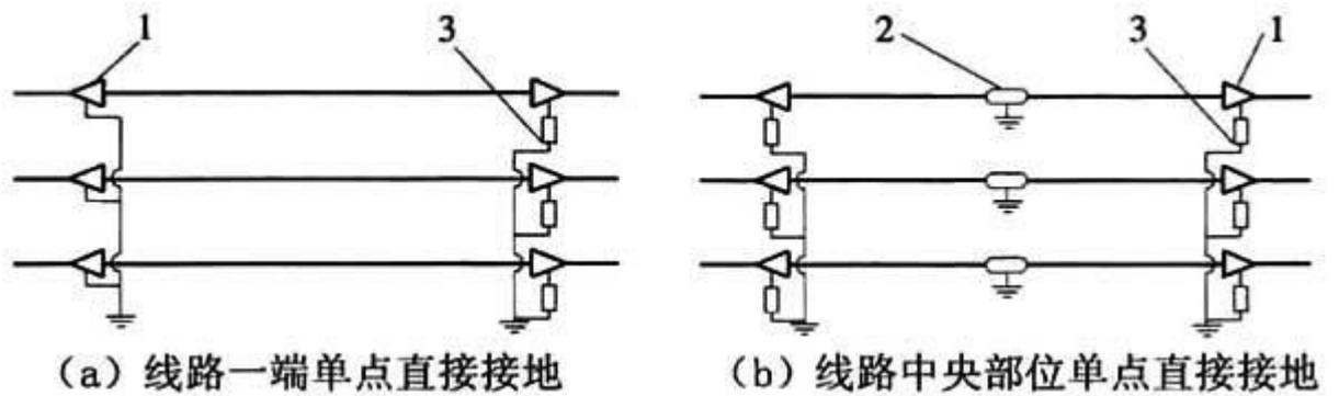
图 4.1.12-1 线路一端或中央部位单点直接接地
