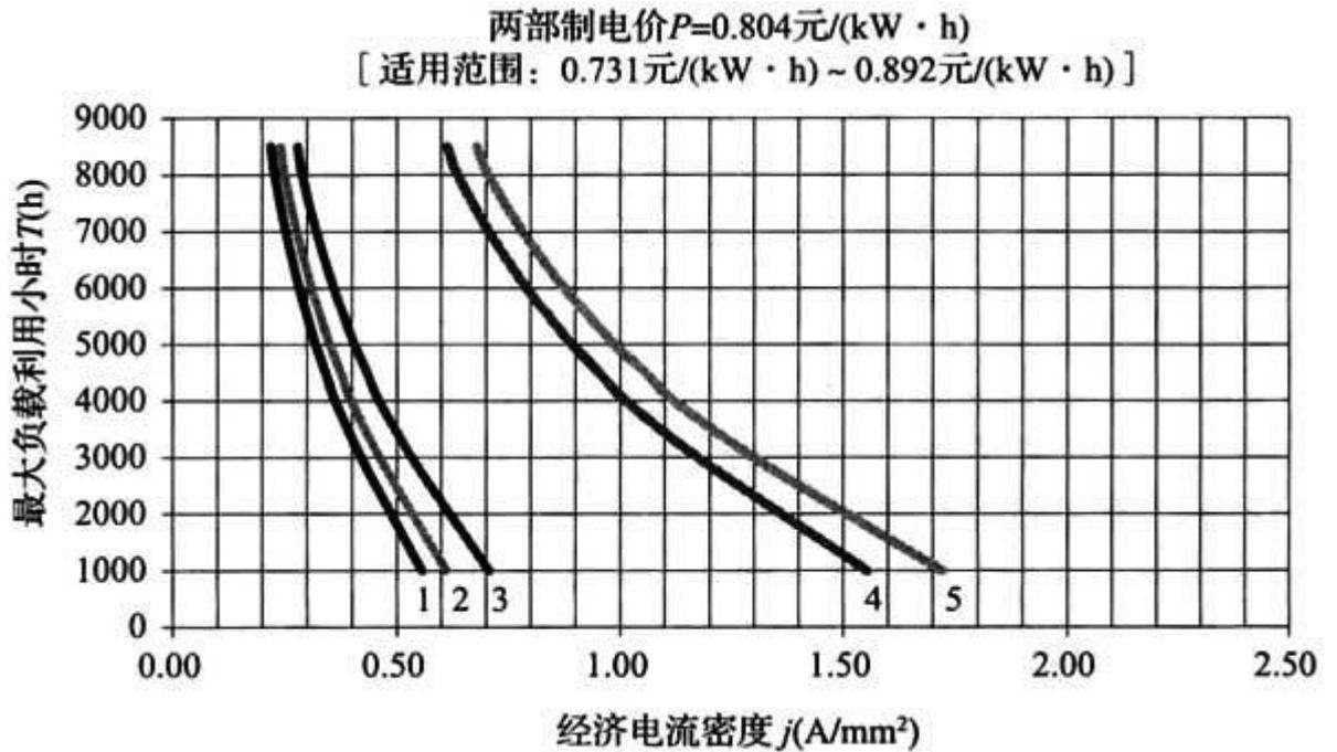
图 B.0.2-12 铜、铝电缆经济电流密度[两部制电价  $P = 0.804$  元 / (kW·h)]
