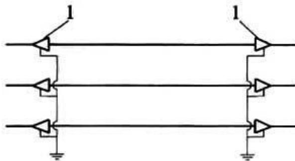
图 4.1.12-2 线路两端直接接地
